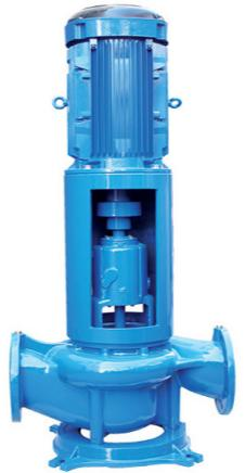
Одноступенчатые насосы моноблочного типа с закрытым рабочим колесом предназначены для перекачки чистых жидкостей с содержанием абразивных частиц размером до 0,1 мм., концентрацией до 0,2% и температурой до 140 °C.
