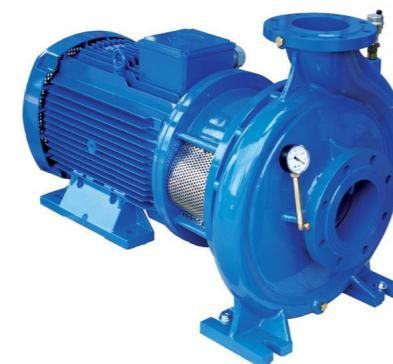
Одноступенчатые насосы моноблочного типа с закрытым рабочим колесом предназначены для перекачки чистых жидкостей с содержанием абразивных частиц размером до 0,1 мм., концентрацией до 0,2% и температурой до 140 °C.
