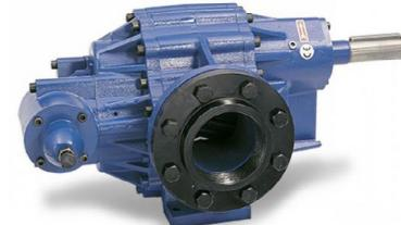
Горизонтальные центробежный насосы с вихревым рабочим колесом предназначены для перекачки жидкостей с содержанием взвешенных и волокнистых частиц соответствующих 90% от диаметра свободного прохода, концентрацией до 10%, температурой до 110 °C.
