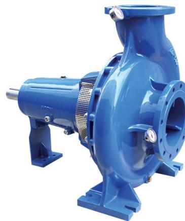
Одноступенчатые насосы консольного типа на раме с закрытым рабочим колесом предназначены для перекачки чистых жидкостей с содержанием абразивных частиц размером до 0,1 мм., концентрацией до 0,2% и температурой до 140 °C.
