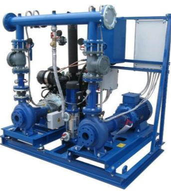
Насосные станции пожаротушения предназначены для автоматической подачи воды в систему пожарного трубопровода на предприятиях промышленного назначения и объектах ЖКХ. Станция состоит из одного или нескольких насосов, которые объединены единой системой управления. Станции могут быть с постоянной или переменной подачей воды.
